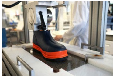
CTC : essai chaussure sur banc de glisse
