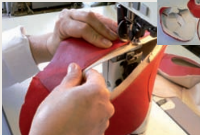
> Assemblage par piqûre de la tige et de la doublure
