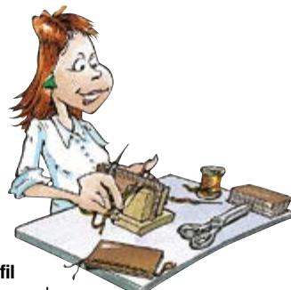
**PIQUAGE MONTAGE.** Chapes, bandoulières, soufflets, doublures en toile ou en PVC, fermetures à glissière, bordures... sont piqués sur des **machines à coudre**. Qu'elle soit plate, pilier ou à canon, la machine apporte une plus grande régularité des points. La particularité des différents bâtis rend possible le piquage en volume de certains articles. Par exemple, les **soufflets** sont assemblés sur la **machine à canon** qui rend le piquage plus aisés.
