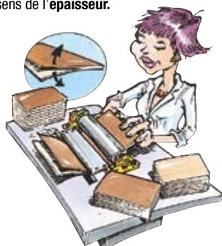
**PRÉPARATION.** L'opération de **parage**, qui consiste à amincir à la main ou à la machine les bords de façon régulière, facilite le rembordage et le montage. Le **rembord** est le terme employé pour décrire un bord qui a été encollé et replié sur lui-même. Le **filetage** est une solution pour amincir un bord franc ou surigner une couture. Manuellement ou mécaniquement, le filet se fait par pression à chaud.
