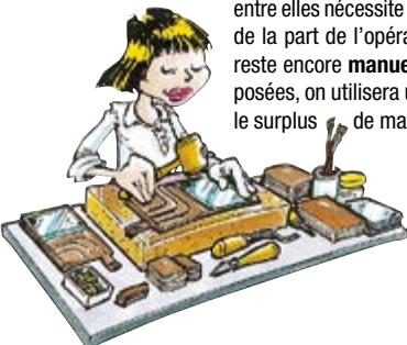
**ASSEMBLAGE.** Assembler les pièces pré-encollées entre elles nécessite de la précision et de la dextérité de la part de l'opérateur : c'est une opération qui reste encore **manuelle**. Une fois les pièces superposées, on utilisera un outil de **surcoupe** pour ôter le surplus de matière et obtenir des bords nets.
